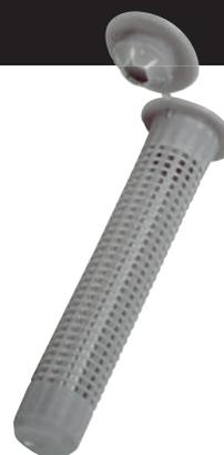
Blíster de 5 tamices de 13x85 mm para aplicar anclajes químicos en ladrillo o piedra hueca. Adecuado para varillas roscadas de 8 mm y 10 mm.
